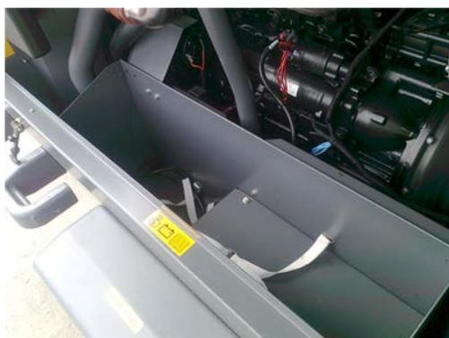
Очень удобно, когда есть место, куда можно положить необходимые в работе инструменты. Для этого к компрессорам Atlas Copco предлагаются дополнительные ящики. Они предотвратят повреждение компонентов установки. Сдвоенный ящик для инструмента входит в стандартную комплектацию компрессоров ХА (Т, Н, S) 146 – 186. Опция не доступна, если опционально установлен генератор.
