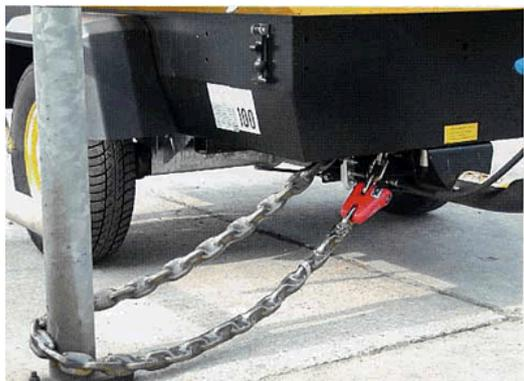
Твердосплавная **цепь** в полимерном чулке с замком, закрепленная на переднем торце компрессора. Позволяет быстро пристегивать компрессор к столбам, деревьям и обеспечивает защиту от кражи.
