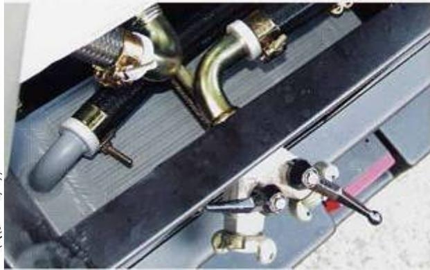
Его использование позволяет получить горячий сухой сжатый воздух с относительной влажностью 1 - 2%. Применяется для предотвращения замерзания молотка, а также для сухой абразивоструйной очистки, окраски, сушки и испытаний трубопроводов.
