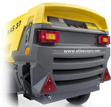
Если Вы хотите перемещать генератор по дорогам общего пользования, то потребуется дорожная сигнализация. Полная **дорожная сигнализация** состоит из фонарей, стоп-сигналов, отражателей и подсветки номера.
