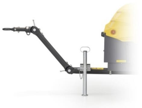
**Опорная пята** для установки генератора в горизонтальном положении на месте работ. Для транспортировки пята складывается.
