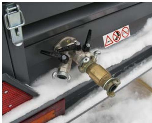
**Обратный клапан** предотвращает возможное попадание воздуха в компрессор. Его необходимо устанавливать при использовании установок, применяемых для работ с пескоструйным оборудованием, при подаче сыпучих веществ, при работе в запыленном, загрязненном пространстве.
